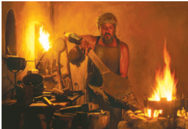
Мал. 106. Міхи для нагнітання повітря в полум'я для підвищення його температури
