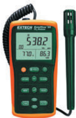
Мал. 39.1. Прилад для контролю за якістю повітря (рівень вмісту вуглецю тощо)
