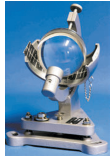
Мал. 18.2. Геліограф — прилад для визначення тривалості сонячного сяйва. Складна лінза концентрує сонячні промені й пропалює стрічку, поділену на годинні відрізки
