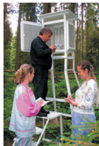
Мал. 19.5. У жалюзійній будці є станційний психрометр — прилад для вимірювання вологості повітря
