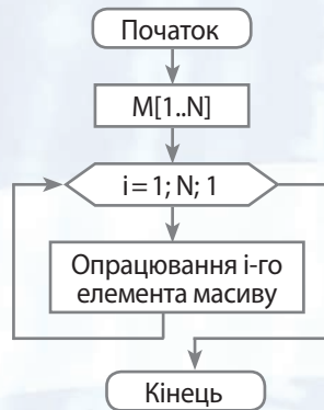
Опрацювання елементів одновимірного масиву M[1..N]
