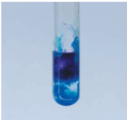
Мал. 31.1. У пробірці знизу — осад купрум(II) гідроксиду, що не прореагував, у верхній частині сполука Купруму з поліпептидним ланцюгом
