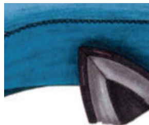
Мал. 12.6. Обробка нижнього зрізу за допомогою клейового матеріалу
