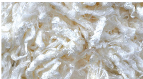
Мал. 1.1. а — волокно віскози; б — тканини виготовлені з віскозного волокна
