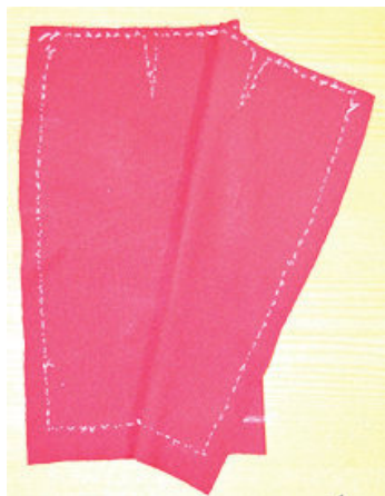
Мал. 8.4. Перенесення ліній викрійки за допомогою копіювальних стібків
