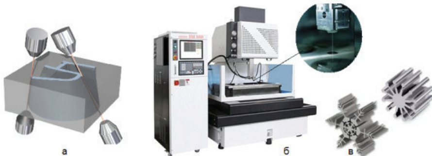
Мал. 9.3. Електроерозійна обробка: а — схема; б — електроерозійний вирізний верстат; в — продукт електроерозійної обробки
